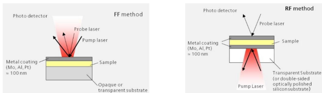
FIGURE 1 – Dispositif de mesure NanoTR et les méthodes de mesures associées (face avant FF ; face arrière RF)
